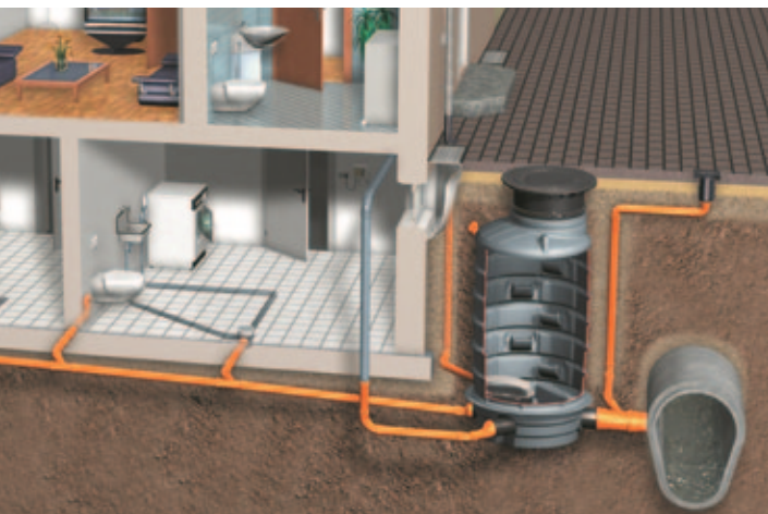
Rückstausicherung außerhalb des Gebäudes
