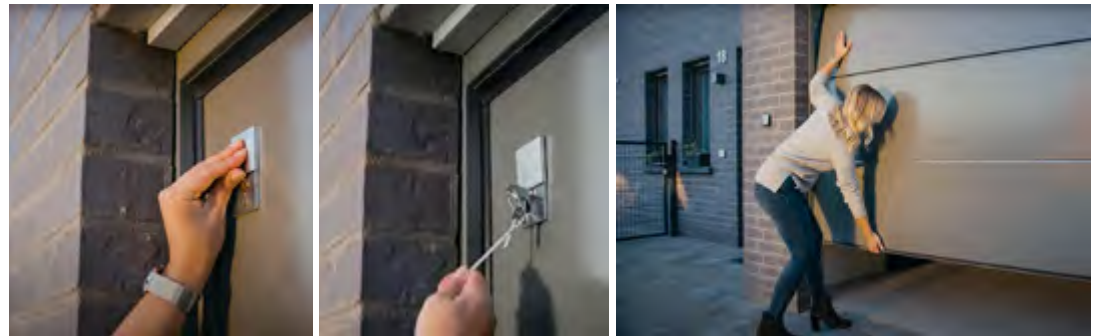
Elektrisch betriebene Garagentore ohne weiteren Zugang zur Garage sollten mit einer Notentriegelung ausgestattet werden. So lässt sich das Tor bei Stromausfall mithilfe des Schlüssels und eines kurzen Zugs am Seil entriegeln. (Fotos: Novoferm/akz-o)
