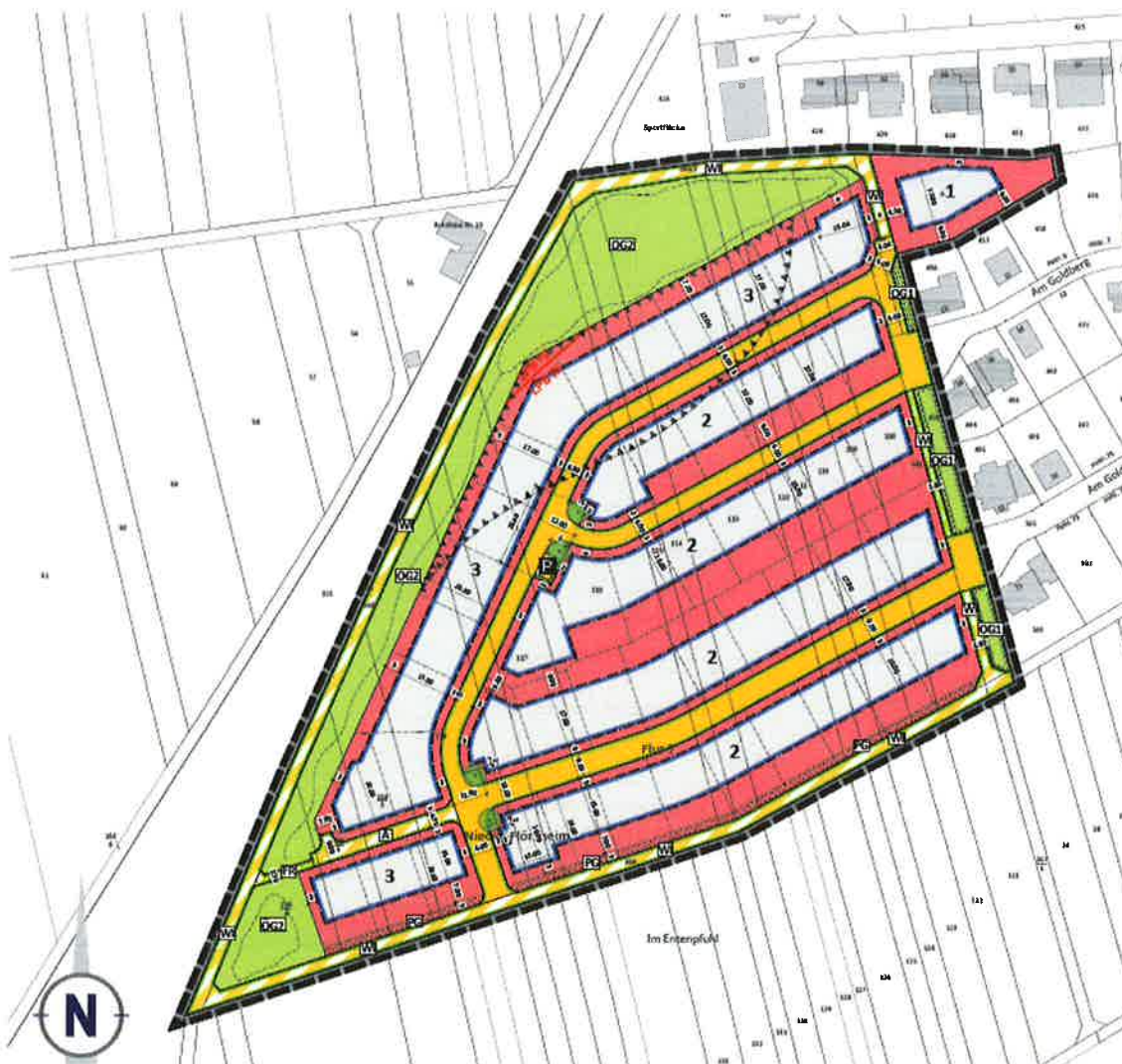
Abbildung 6: Vorentwurf des Bebauungsplanes „Am Goldberg, 2. Bauabschnitt“ mit Retentionsbecken in den Grünbereichen im Norden und Westen
